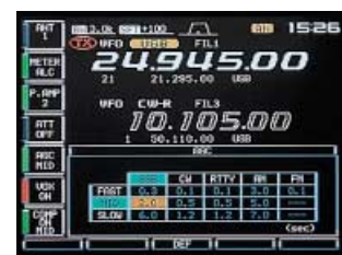
Beispiel für die Einstellung der AGC-Zeitkonstante für SSB-Mid, 2,0 s.
