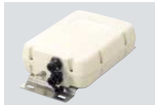
AH-4 AUTOMATIC-TUNER für KW und 6 m Passt im Bereich von 3,5 bis 54 MHz Drahtantennen ab 7 m Länge an
